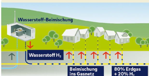
Beimischung von Wasserstoff in das Erdgasnetz
